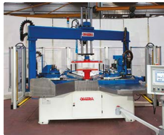
Станок для двойной сплошной отбортовки итальянского производства OMEGA
